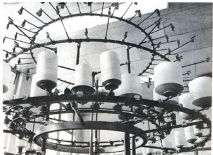
Detalhe de uma Usina Têxtil, em Santo André, SP, vendo-se as bobinas de fiação numa máquina circular de malharia.
